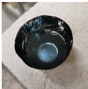
(a) Verre recuit après la seconde fusion.
