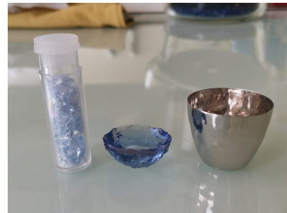
(b) Morceaux de verre extraits du creuset.
