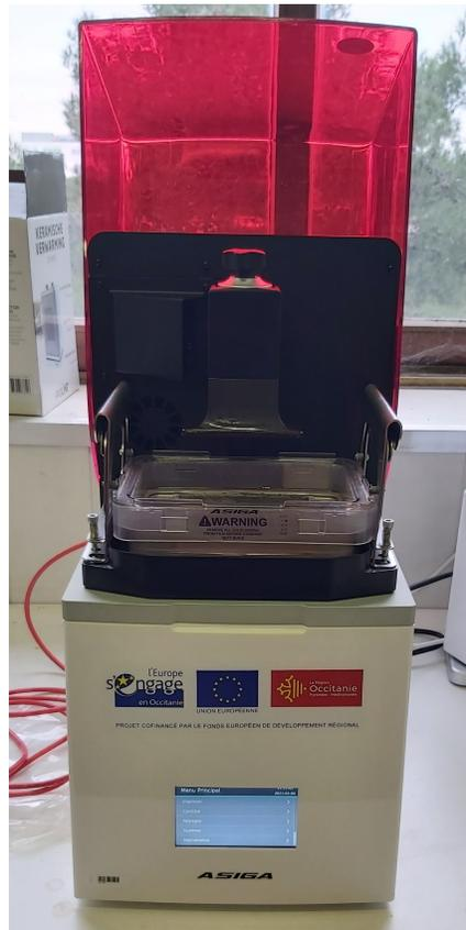
FIG. 2.2 Machine de stéréolithographie DLP, Asiga Max X27
