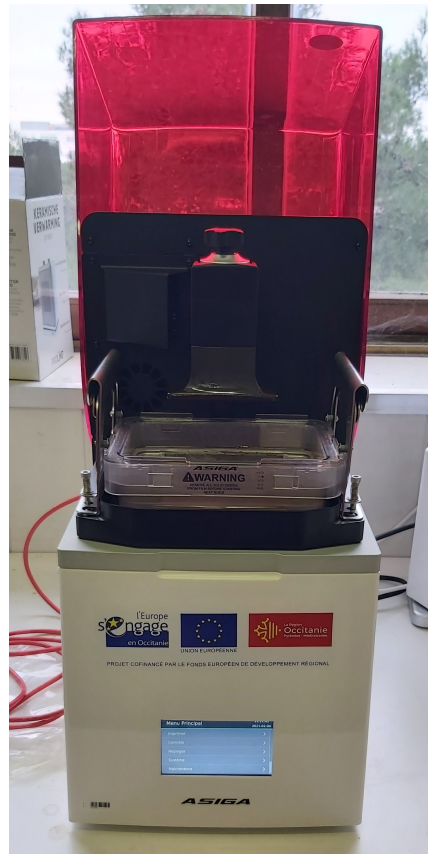
FIG. 2.2 Machine de stéréolithographie DLP, Asiga Max X27
