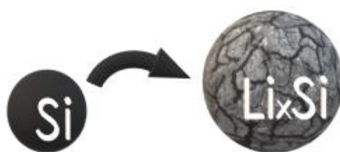
Figure i.3 Schéma de l'expansion volumique lors de la lithiation du silicium (pas à l'échelle).
