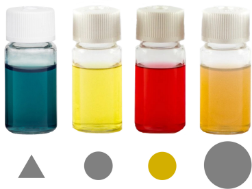
FIGURE 2 – De gauche à droite : solutions aqueuses de nanoparticules triangulaires d'argent (40 nm), de nanosphères d'argent (40 nm), de nanosphères d'or (40 nm) et de nanosphères d'argent (80 nm) [26]
