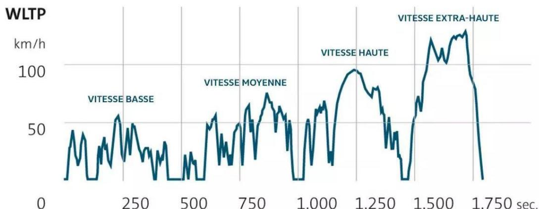
Figure 78 : Evolution des vitesses du véhicule lors d'un cycle WLTP [219]. Il est découpé en plusieurs phases correspondant à des profils de vitesses (allant de basse à extra-haute). Il est possible de le moduler en n'utilisant que certaines phases.
