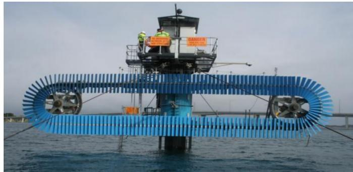
FIGURE 1.13 – Une hydrolienne bi-axiale à axe horizontal : AN-150 de SIMEC Atlantis Energy Ltd, 150kW.
