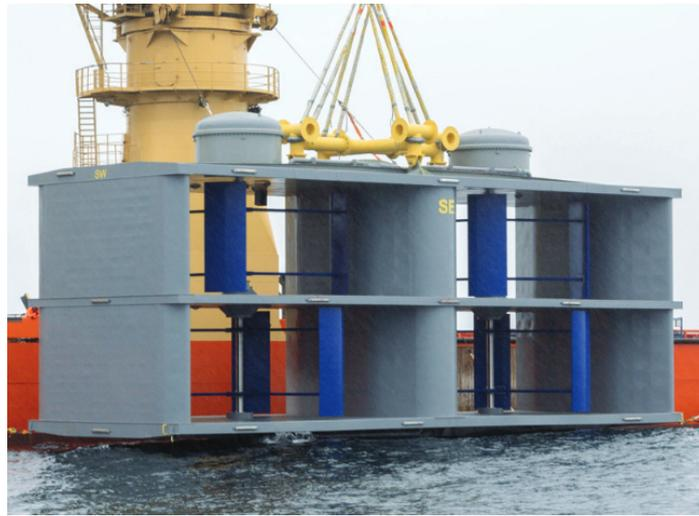
FIGURE 1.7 – Exemples d’hydroliennes à axe vertical : turbine OceanQuest d’HydroQuest, 1MW (250kW par rotor).
