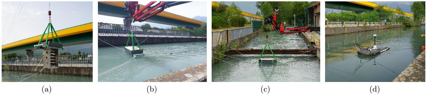
FIGURE 1.12 – Journée d’essais de la turbine bi-axiale dans le canal de la Romanche, au sud de Grenoble, juin 2022. Positionnement de la turbine au centre du canal à l’aide d’une grue et de cordages (a-c). Mesure du profil de courant par ultrasons (d).
