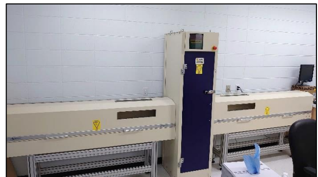
Figure 2-6. GEOTEK MSCL-XCT du laboratoire de géologie marine de l'ISMER
