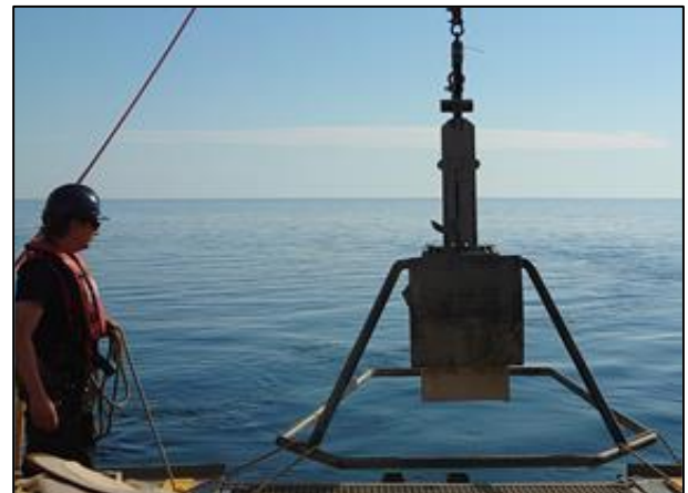
Figure 2-3. Déploiement du carottier à boîte sur le pont du N/R Coriolis II lors de la mission SLIDE-2020.
