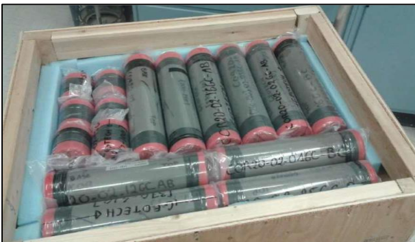
Figure 2-11. Sections de carottes entières destinées aux mesures géotechniques.
