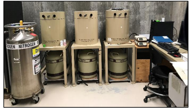
Figure 2-9. Compteur gamma GMX50-S d'Ortec dans le laboratoire sous-terrain de la station aquicole (ISMER).
