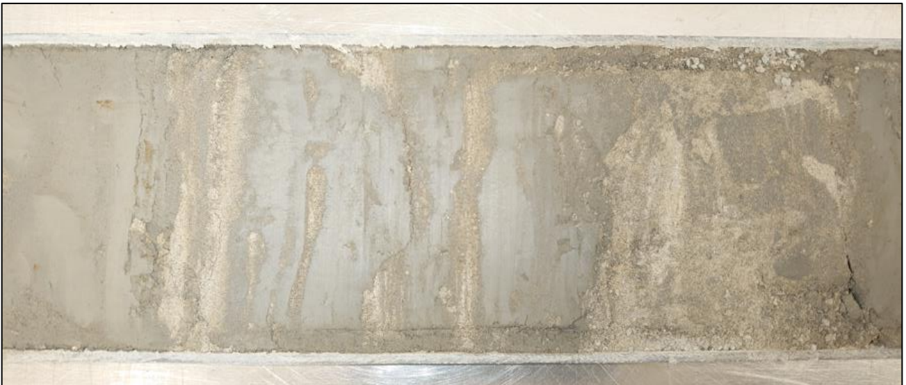
Figures de liquéfaction dans une carotte sédimentaire prélevée dans la région de Charlevoix Liquefaction features in a sediment core from the region of Charlevoix
