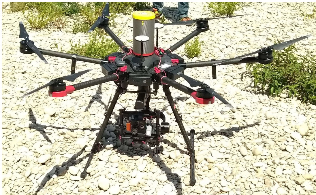
Figure 11: Caméra hyperspectrale montée sur le drone. La nacelle ajuste automatiquement la position de la caméra pendant le vol et maintient sa stabilité.
