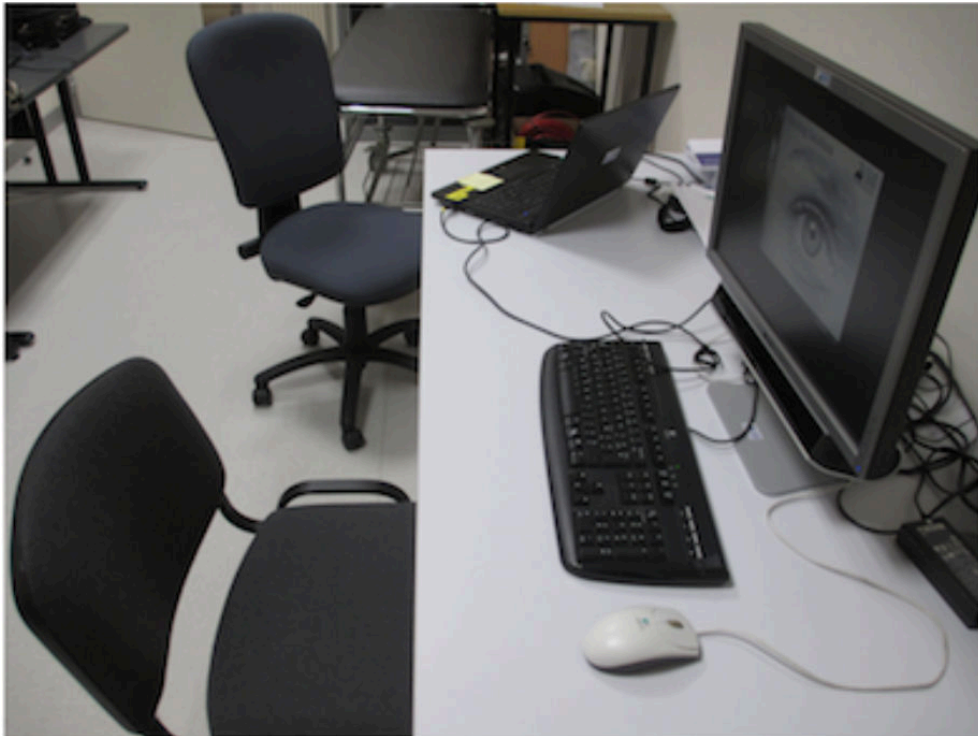
Figure 19 : Dispositif d'oculométrie (moniteur externe avec écran de visualisation Dell 22 pouces et ordinateur portable iViewX Workstation)
