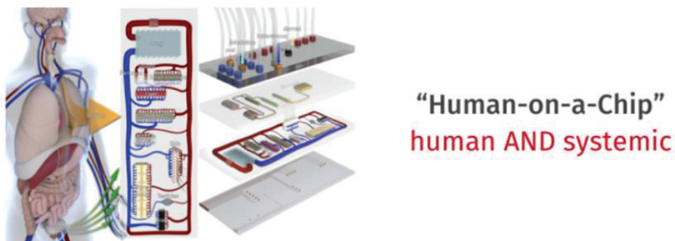
Figure 26 : Schéma commercial du « human-on-a-chip » développé par TissUse. Le système permet de mettre en relation à façon différents compartiments cellulaires du corps humain, comme la peau, les reins, le cœur, le cerveau, les cellules lymphatiques, les intestins, le pancréas, ...
