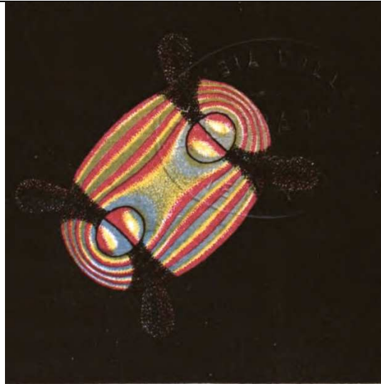
Figure 54 : Extrait d'une planche colorée des anneaux colorés d'un cristal biaxe 578 .
