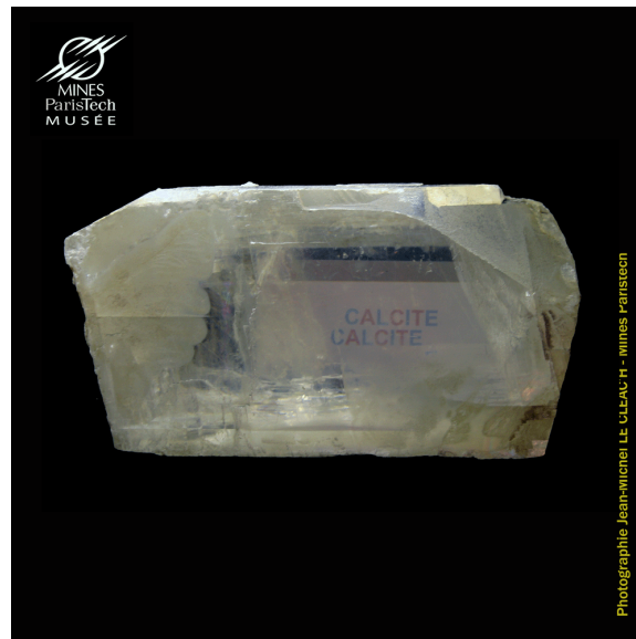
Figure 26 : Démonstration de la double réfraction chez le spath d'Islande.
