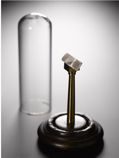
Figure 22 : Photographie d'un prisme à simple vue de W. Nicol 357 .
