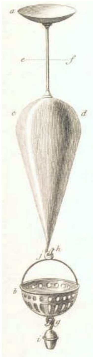
Figure 11 : Balance de Nicholson pour mesurer la pesanteur spécifique d'un échantillon 143 .
