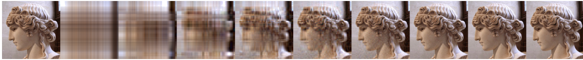
FIGURE 1.5 – Approximations successives d’une image, avec 1, 2, 4, 8, 16, 32, 64, 128, puis toutes les valeurs singulières à partir de la matrice de luminosité des pixels. L’image originale est représentée à gauche. Source : Wikipedia .
