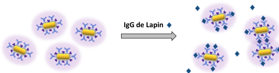
Figure 27 : Schéma général de la détection de l'IgG de lapin par les sondes AuNR@SiO 2 (nanosonde 1), AuNR@SiO 2 -MPTMS/TEBA (nanosondes 2/3)
