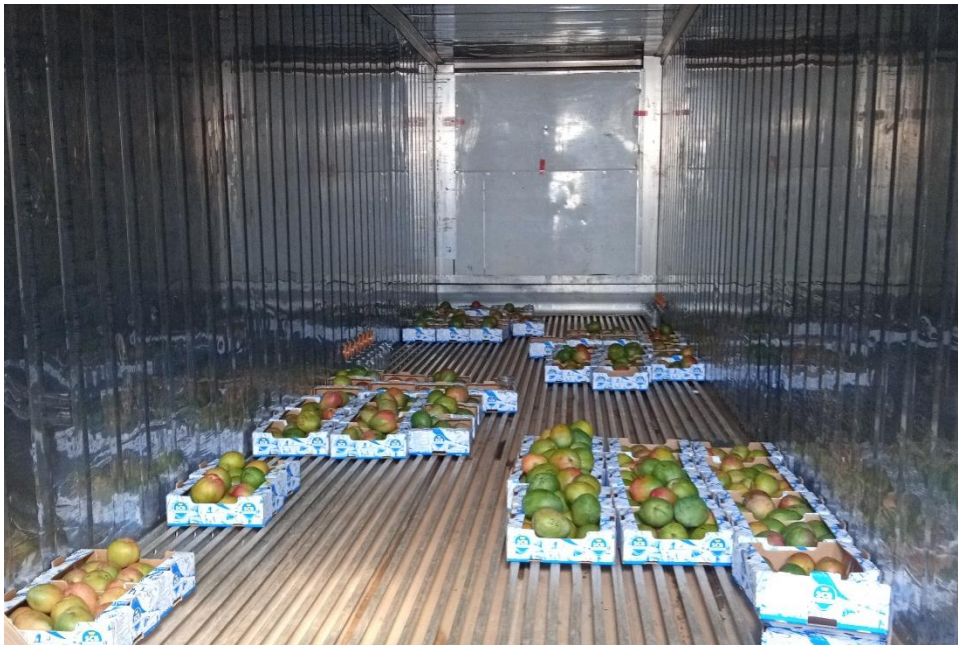
Figure 10: Disposition des mangues dans le conteneur frigorifique
