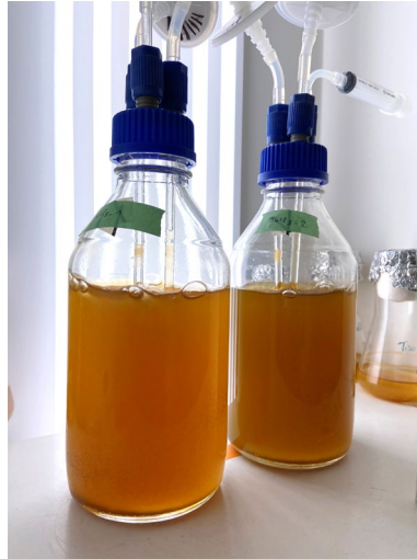
Figure 52. Photo des duplicats de culture de T-4cl3 dans des bouteilles de 1 L après 7 jours de culture. Le même système a été mis en place pour les cultures de T-5cl6 et de la souche CCAP 927/14.
