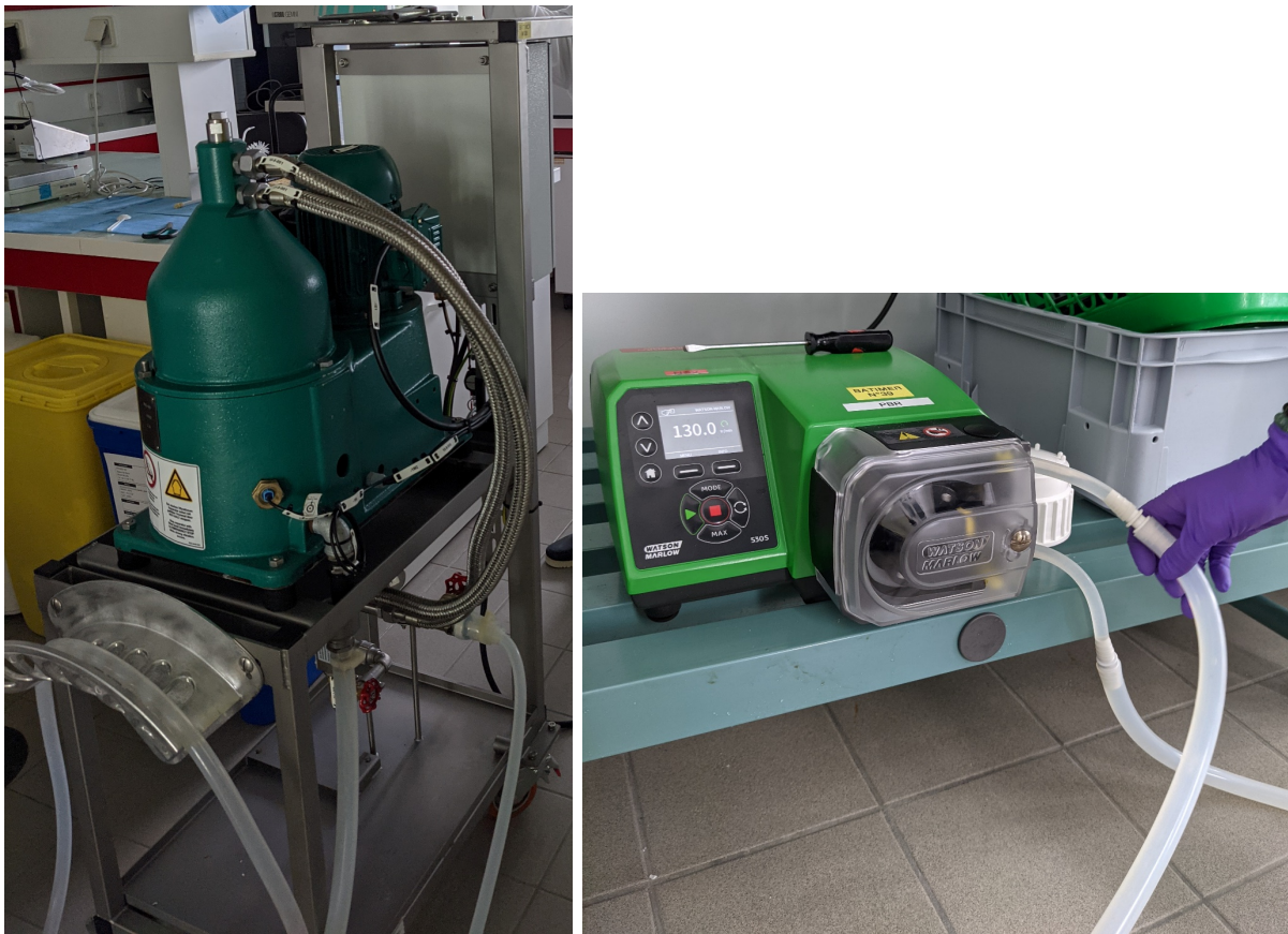
Figure 55. Centrifugeuse à assiette (à gauche) et pompe péristaltique (à droite) permettant d'acheminer la culture.
