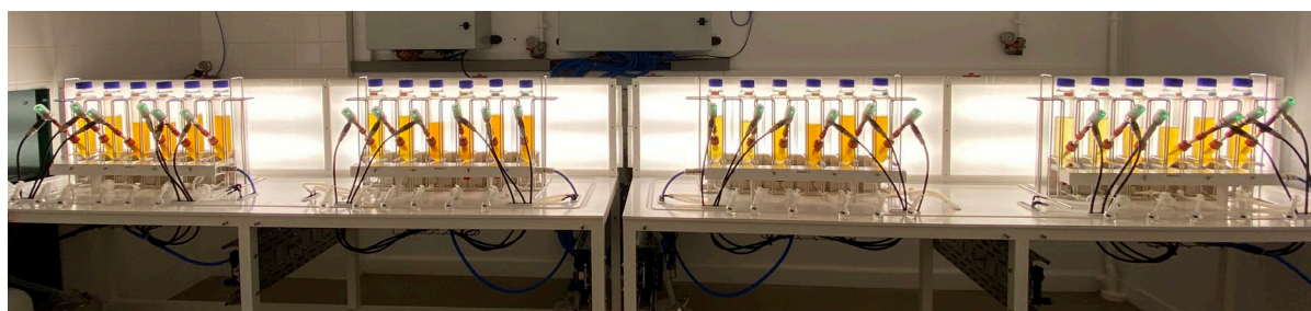
Figure 51. Photo du banc de phénotypage des cultures de T-4cl3, T-5cl6 et de la souche CCAP 927/14 dans des PBRs de 350 mL après 7 jours de culture en duplicats.
