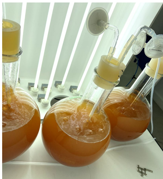
Figure 53. Photo des duplicats de culture de T-4cl3 dans des ballons de 6 L après 7 jours de culture. Le même système a été mis en place pour les cultures de T-5cl6 et de la souche CCAP 927/14.
