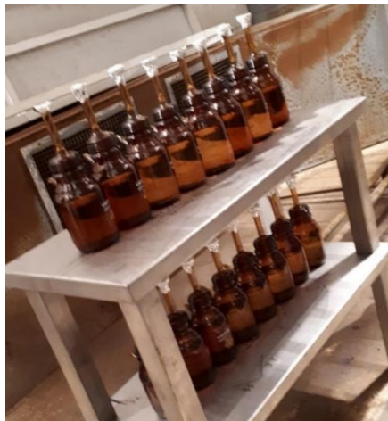
Figure III-7. Prise de vue après irradiation des flacons en verre borosilicaté contenant les solutions alcalines additionnées de SP mises en équilibre avec du mortier CEM I broyé.
