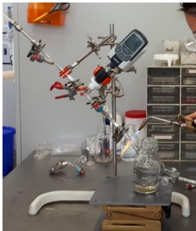
Figure 14. Boîte à gants sous atmosphère inerte (Ar) pour le remplissage des flacons à irradier (a) et rampe de scellement (b).
