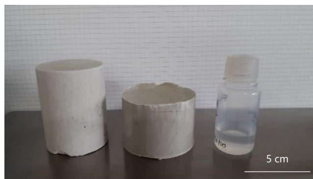
Figure 11. Photo d'un bloc de coulis à base de CEM I avant et après pressage ainsi que le volume d'eau porale récupéré correspondant à 10 mL pour une éprouvette de 125 cm 3 initialement (de gauche à droite).
