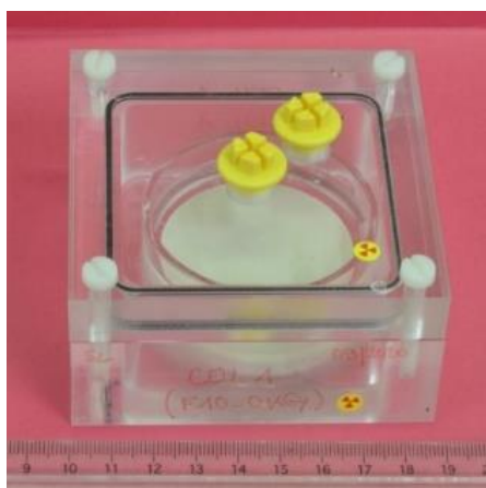
Figure VI-11. Photo d'une cellule de diffusion entrante en 152 Eu.
