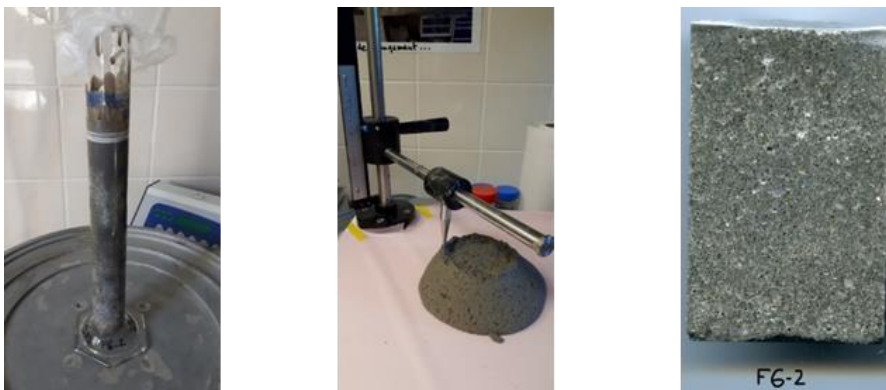
Figure 12. Photographies de mortier - De gauche à droite, le mortier non durci coulé dans une éprouvette en verre, résultat du test d'affaissement par la méthode du cône d'Abrams et section polie de l'échantillon après découpe après 28 jours de cure.
