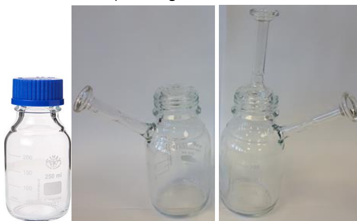
Figure 13. Flacon en verre Duran de 250 mL : simple, à sceller sans et avec système pour l'analyse des gaz de radiolyse (de gauche à droite).
