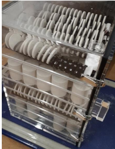
Figure III-8. Matériaux cimentaires à base de CEM I découpés sous forme de blocs ou de disques maintenus en conteneur étanche et sous atmosphère inerte (Ar).
