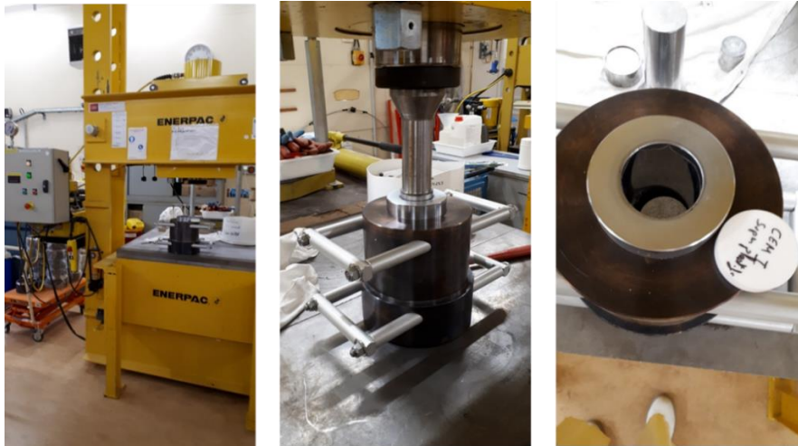
Figure 10. Presse hydraulique, moule pour extraire l'eau porale et échantillon dans le moule d'extraction (de gauche à droite).
