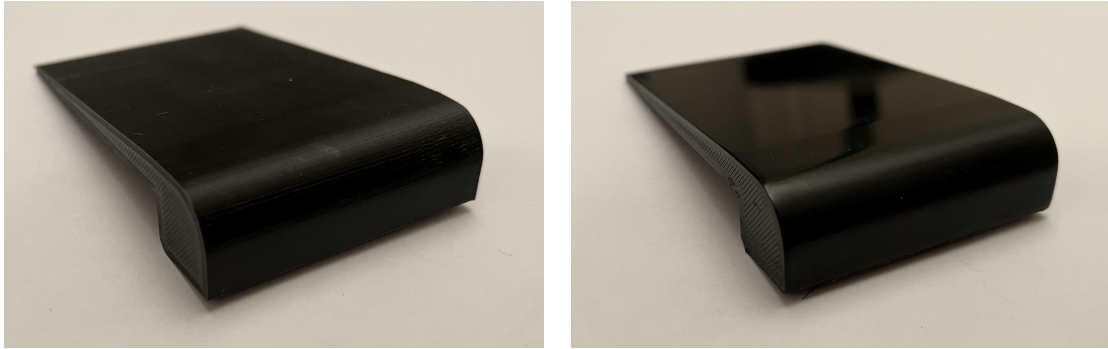
FIGURE 2.14 – Exemple de demi-tuyère imprimée en 3D. Gauche : brute d'impression. Droite : polie à p4000.
