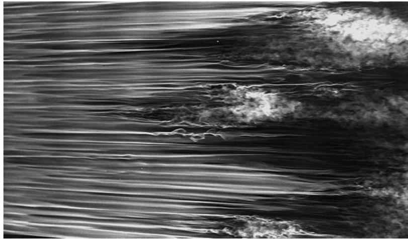
FIGURE 1.12 – Visualisation de structures allongées dans une couche limite incompressible, correspondant aux modes de Klebanoff. L'écoulement se fait de gauche à droite. Les zones claires correspondent à une concentration plus forte de fumée (écoulement basse vitesse), mettant en avant les perturbations de haute et basse vitesse longitudinale alternant dans la direction transverse de la couche limite. Issue de Alfredsson et Matsubara (2000).
