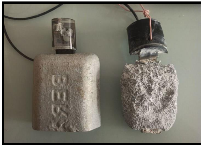
Figure 19 : Comparaison entre une anode galvanique neuve (à gauche) et corrodée (à droite).
