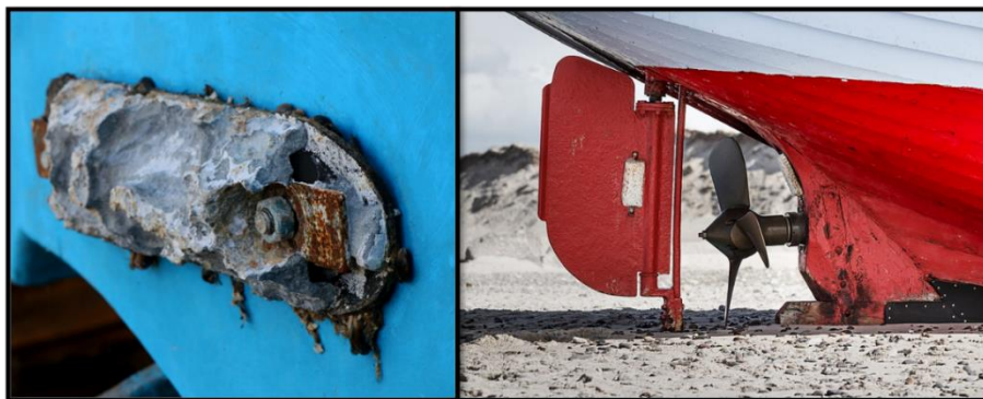
Figure 4 : Anodes galvaniques installées sur la coque et le gouvernail de navires pour les protéger de la corrosion.
