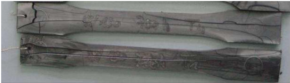
FIGURE 1.24 - Photographie d'éprouvettes de PA66 après 700 h d'immersion dans l'eau à 130°C. D'après [LEDIEU 2010].
