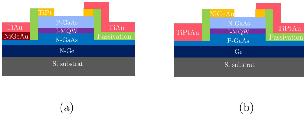
Figure III.4: Schémas des différents contacts selon les empilements : (a) empilement AlGaAs et (b) empilement quaternaire.
