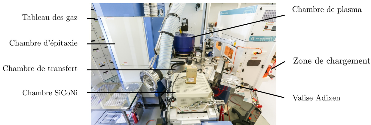
Figure A.2: Photographie des différentes chambres du bâti EPVOM, adaptée de [83].
