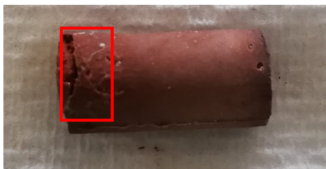
Figure 87 Eprouvette D après 28 jours en solution sulfatée
