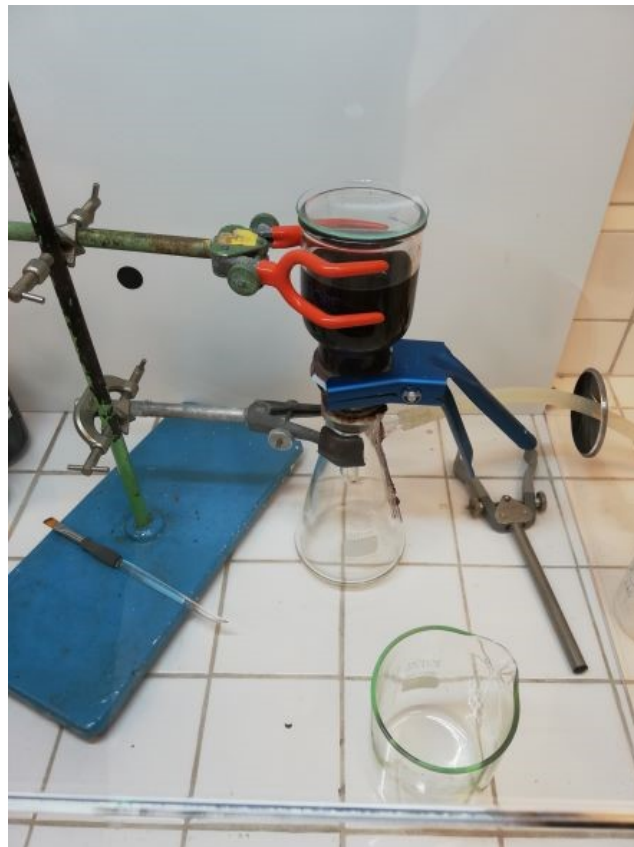
Figure 27 Montage de filtration lors du protocole SAM
