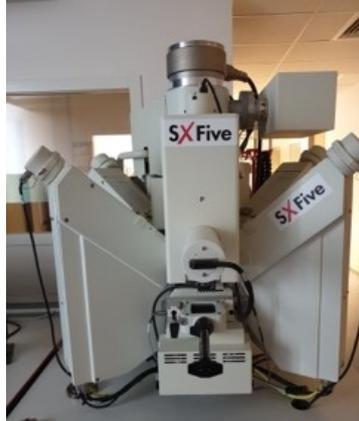
*Figure 35 Microsonde de Castaing « SX Five » (CAMECA)*
