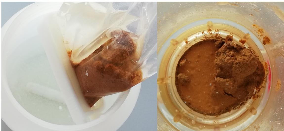
Figure 84 Eprouvettes après 90 jours dans la solution sulfatée
