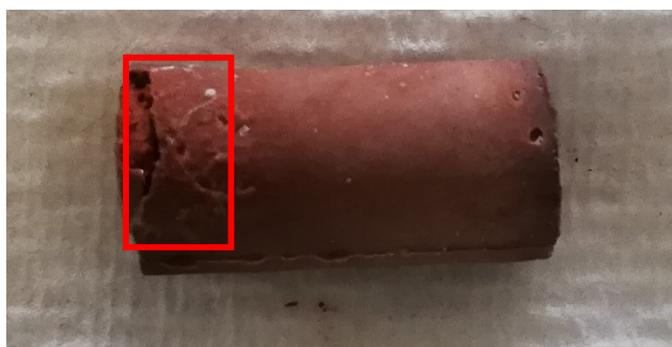
Figure 87 Eprouvette D après 28 jours en solution sulfatée
