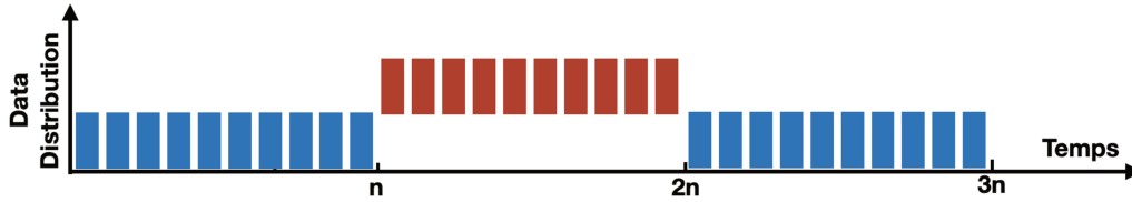
FIGURE 5.7 – Simulation d’un flux non-stationnaire avec deux dérives abruptes, passant du concept de \mathcal{D}_1 au concept de \mathcal{D}_2 à l’instant n , puis remplaçant le concept de \mathcal{D}_2 par le concept de \mathcal{D}_1 à l’instant 2n .
