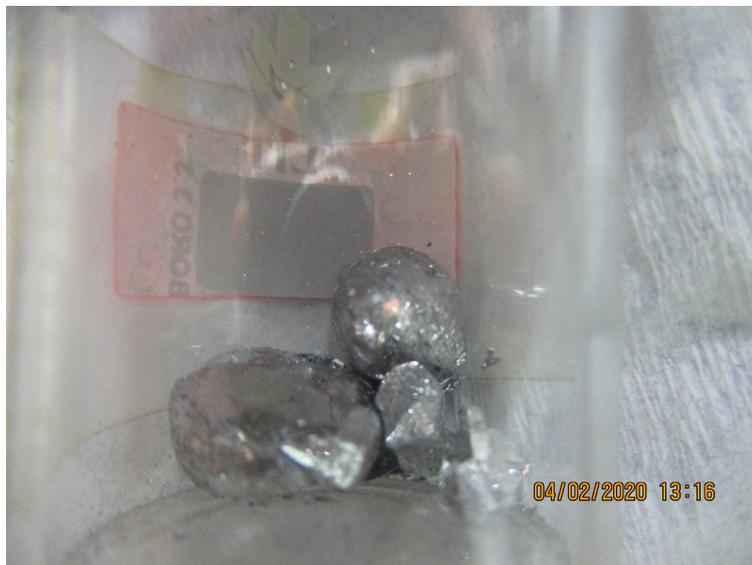
FIGURE 3.6 – Cristaux de Sb<sub>2</sub>Te<sub>3</sub>
