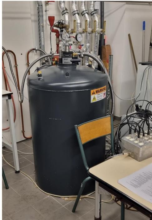
FIGURE 2.26 – Photographie du réservoir à hélium du PPMS.
