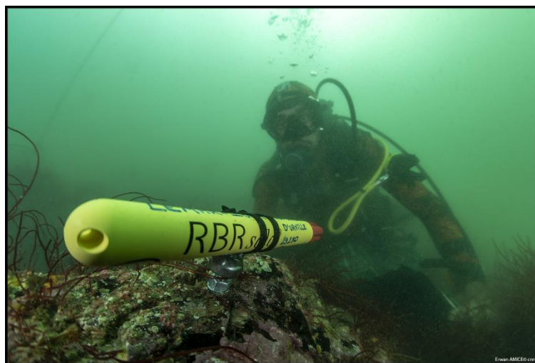
Figure 4 : Sonde de température installée à l'interface eau-sédiment (© Erwan Amine).
