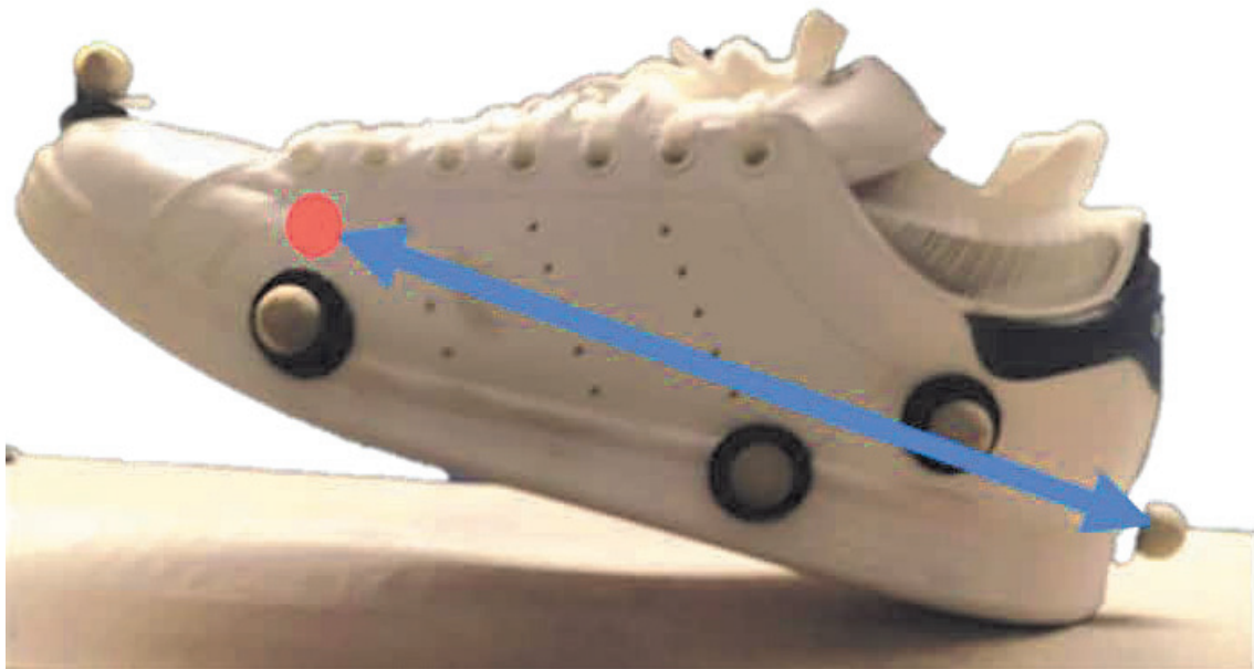
Figure 10 : Méthode pour calculer l'angle d'attaque du pied au sol, le point rouge représentant le point moyen situé entre le marqueur du 1 er et le 5 ème métatarsien.
