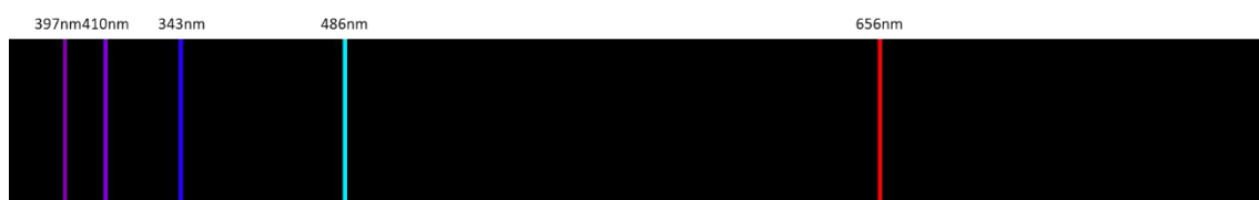
Spectre d'émission de l'hydrogène dans le spectre du visible (série de Balmer)
