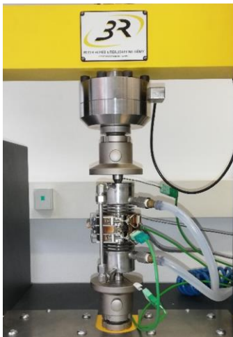
Figure IV - 1 : Photos du dispositif de l'enceinte hydrothermale entre les mâchoires de la presse automatique et du logiciel SyntX pendant une acquisition.
