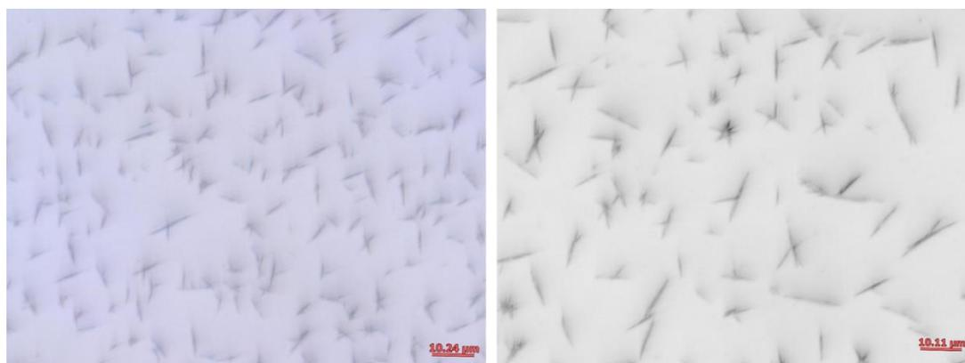
Figure IV.33 : Images de microscopie confocale. Solution de Tz-thio ( $2.5 \text{ mg} \cdot 0.5 \text{ mL}^{-1}$ ) dans le chlorobenzène sur silicone. Conditions de déposition : spin-coating, 2000 rpm, 45s,  $20^\circ\text{C}$  (à gauche) et 1000 rpm, 45s,  $20^\circ\text{C}$  (à droite).
