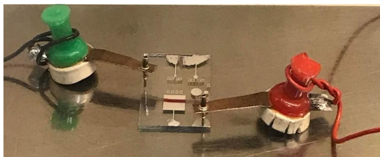
Figure IV.42 : Photo du dispositif lors de la mesure de SCLC.
