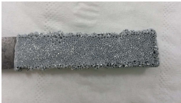
FIGURE 3.5 : Photo de dépôt de zinc en présence de 10 u.a. d'additif B et de de 1,25 u.a. d'agent dépolarisant (cf tableau 4.4)
