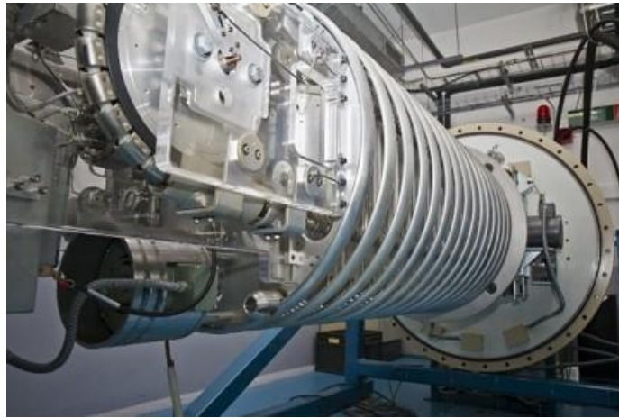
Figure 42 : Photo de l'accélérateur Pelletron fabriqué par la société NEC.
