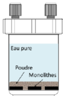
Figure 49 : Représentation schématique d'un Savillex® contenant de la poudre de verre ISG non irradié et des monolithes.
