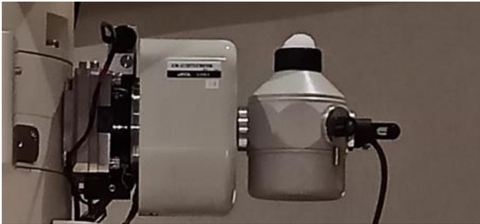
Figure 57 : Photo du porte échantillon rempli d'azote liquide.
