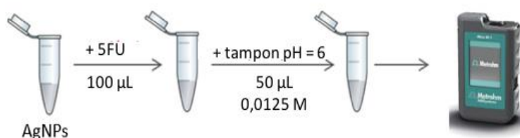
Figure 21 : Séquence d'analyse d'un échantillon de 5-fluorouracile en SERS avec un spectromètre Raman portable. Nanoparticules d'argent (AgNPs, volume = 500 \mu\text{L} ), 5-fluorouracile (5FU, volume = 100 \mu\text{L} ), tampon citrate (0,0125 M, pH = 6, volume = 50 \mu\text{L} ).
