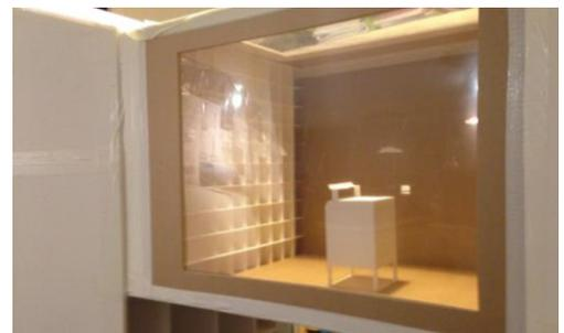
Figure 271. Détail de notre maquette de bâtiment dans la veine d'air
