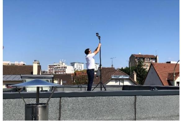
Figure 153 Vue toiture de l'anémomètre connecté sur une maison à Arcueil (92) par D. Serero
