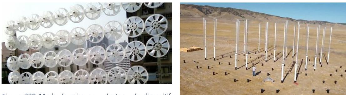
Figure 230 Mode de mise en « cluster » de dispositifs éoliens (fonctionnement en groupes de turbines rapprochées)
