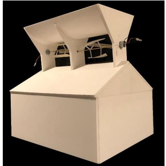
Figure 249. Maquette d'étude initiale avec 2 turbines. Leur géométrie n'est pas adaptée au foil avec un régime moins important sur la turbine en hélice.
