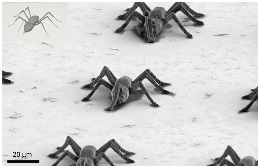
FIGURE 2.10 – Image MEB de fourmis imprimées en suivant le protocole classique.
