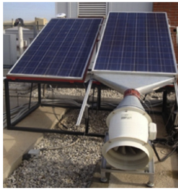
(a) Système de ventilation forcée [50]
