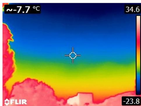
FIGURE 1.15: Cliché thermique du ciel par temps clair et proche de l'horizon, prise sur du campus de la Doua avec une caméra infrarouge *FLIR*, montrant la dépendance angulaire du rayonnement atmosphérique (la température affichée est obtenue en fixant l'émissivité égale à l'unité)
