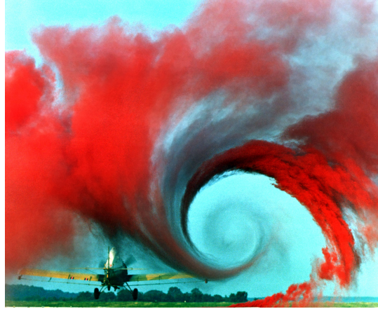
FIGURE 4.10 – Écoulement en aval d'une aile d'avion, NASA Langley Research Center.
