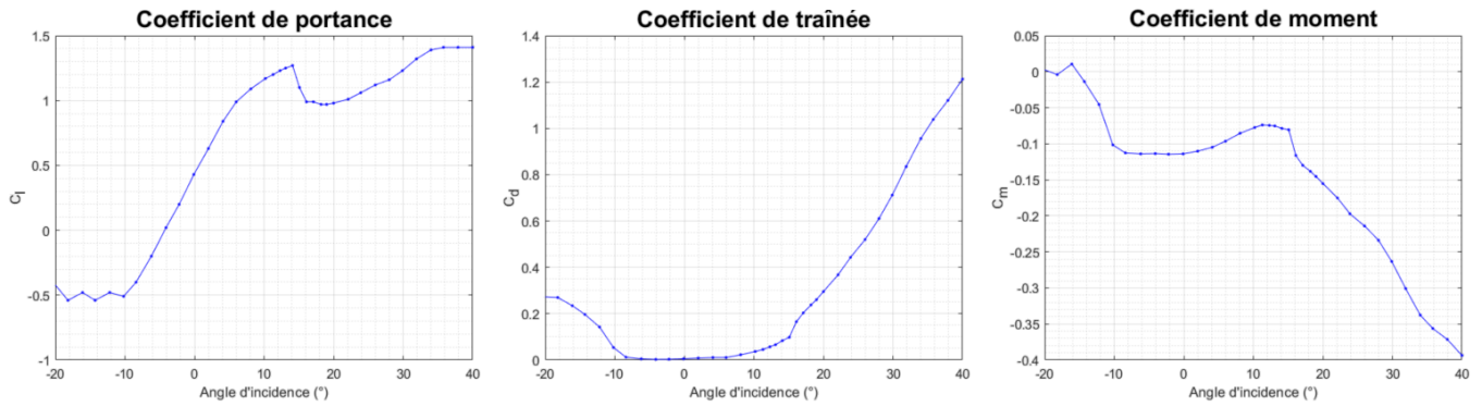
FIGURE 5.11 – Polaires aérodynamiques du profil S801 (données de OSU [123]).
