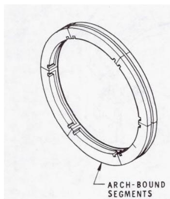
Figure 9. Schéma du premier joint segmenté [9]
