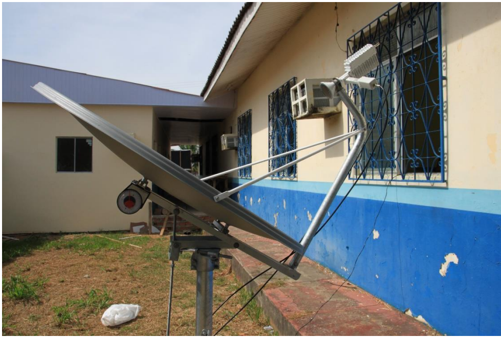
Figure 47: Rapporteur d'angle accroché à la parabole
