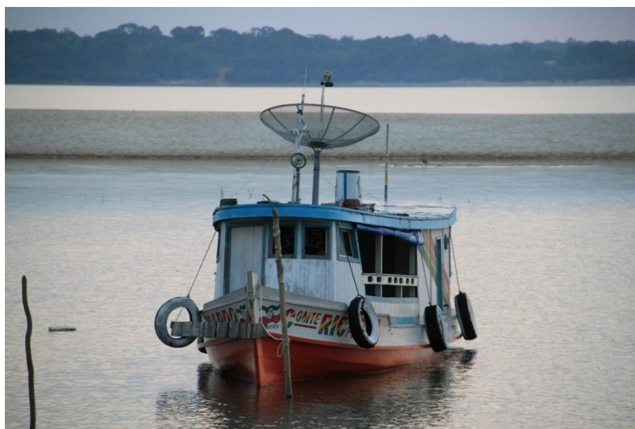
Figure 57: Bateau ancré à la plage à Maués avec une parabole. Comme la région amazonienne est juste au-dessous de la ligne de l'Équateur terrestre, où les satellites orbitent, la parabole, qui doit être alignée à la verticale, peut fonctionner même en mouvement.
