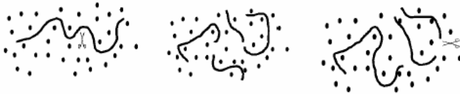
Figure I.6 : Mécanisme de relaxation avec coupure et recombinaison des micelles
