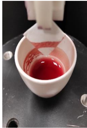
Figure 3.73 : Photographie d'un filtre en PP après 24 h de dip coating dans une solution d'hémoglobine à 500 mg/L.
