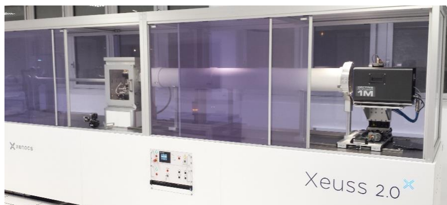
Figure 2.1 : Photographie du diffractomètre Xeuss 2.0 utilisé pour les mesures de SAXS.
