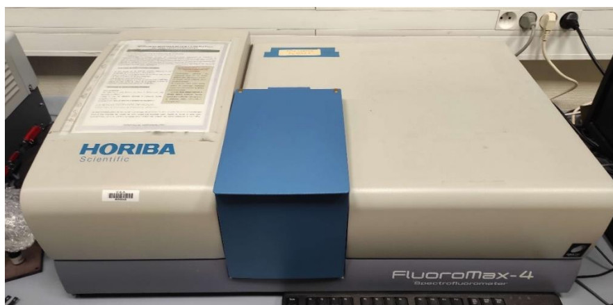
Figure 2.10 : Photographie du fluorimètre Horiba Jobin-Yvon Fluoromax 4 utilisé pour les mesures de fluorescence.
