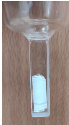
Figure 3.51 : Photographie d'un filtre ayant adsorbé de l'hémoglobine dans un tonomètre avec 100 \mu L de tampon phosphate 100 mM à pH 7,4.
