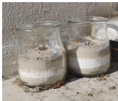
Figure 6.3 : Photographie d'échantillons de microparticules de PP et de microparticules de PE laissés vieillir en extérieur.
