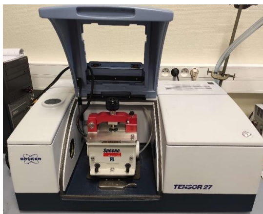
Figure 2.3 : Photographie du spectromètre infrarouge Bruker Tensor 27 IR équipé de l'accessoire ATR Specac Golden Gate, utilisé pour les mesures infrarouge.
