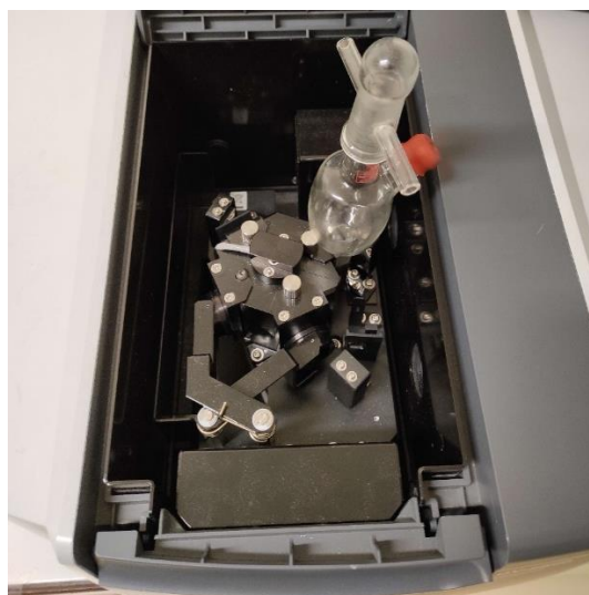
Figure 2.8 : Photographie de la sphère d'intégration Shimadzu ISR-2600PLUS avec un tonomètre positionné pour des mesures en réflexion diffuse.
