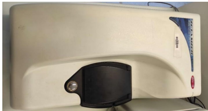
Figure 2.11 : Photographie du Zetasizer utilisé pour les mesures de DLS.
