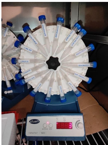
Figure 3.17 : Tubes contenant des solutions de protéines en contact avec des microplastiques, sur roue.
