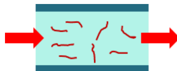
Figure 2.31 : Schéma de la mise en contact d'une protéine et d'un tube en plastique par circulation.
