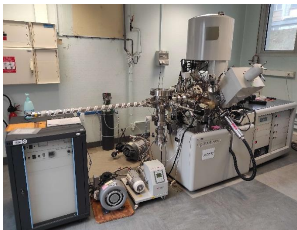
Figure 2.4 : Photographie du spectromètre Kratos Axis Ultra DLD utilisé pour les mesures XPS.
