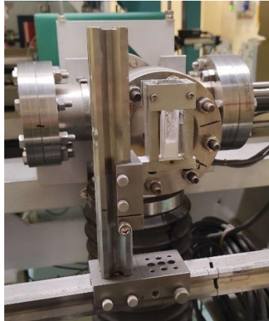
Figure 2.13 : Cuve contenant 300 mg de microparticules de plastique en sortie de l'accélérateur linéaire d'électrons.
