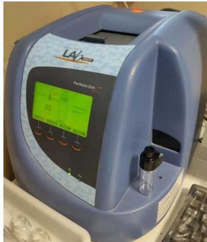
Figure 2.9 : Photographie du Turbiscan LAB et de la cuve utilisée pour les mesures de turbiscan.
