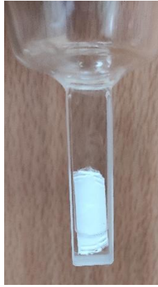
Figure 2.40 : Photographie d'un filtre ayant adsorbé de l'hémoglobine trempant dans un tonomètre avec 100 µL de tampon phosphate 100 mM à pH 7,4.
